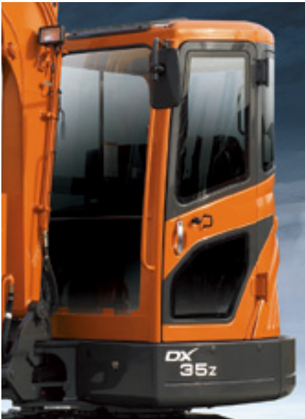
Cabina de operaciones confortable Una cabina espaciosa, de impactos minimizados y bajo nivel de ruidos, con cristales de seguridad y visibilidad en los cuatro costados. La ventana del lado derecho se abre a efectos de la ventilación.
