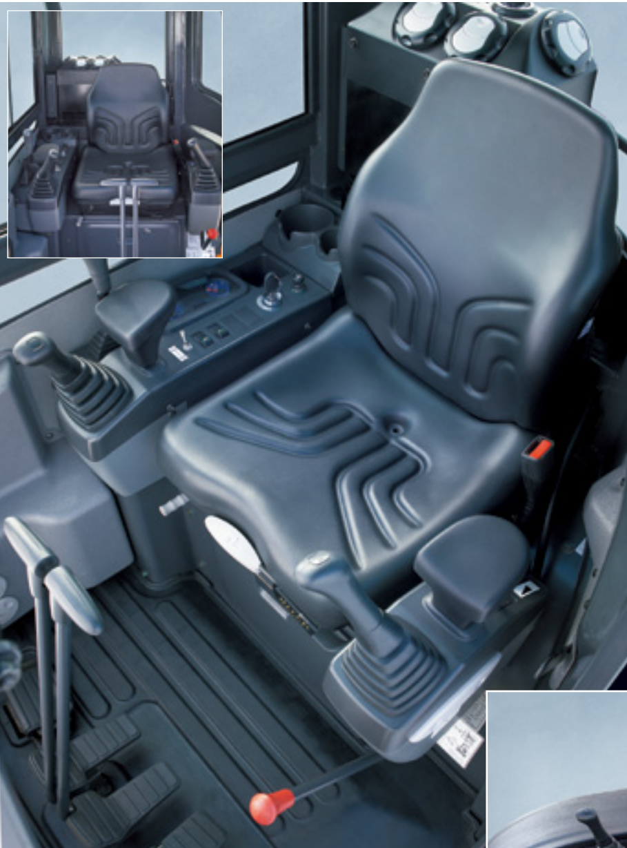
Cabina de operaciones confortable Una cabina espaciosa, de impactos minimizados y bajo nivel de ruidos, con cristales de seguridad y visibilidad en los cuatro costados. La ventana del lado derecho se abre a efectos de la ventilación.
