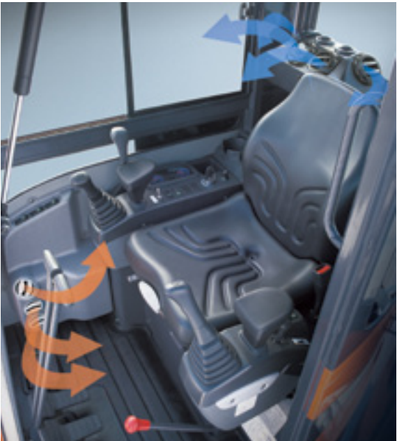
Descongelador El sistema de ventilación de alta calidad se ha instalado en la ventana trasera derecha y provee un excelente rendimiento ya sea en clima frío como caluroso. El mismo elimina en forma indistinta y muy eficiente la escarcha y la humedad y brinda al operador condiciones más seguras de trabajo bajo cualquier condición climática. (Únicamente para el Tipo Cabina)
