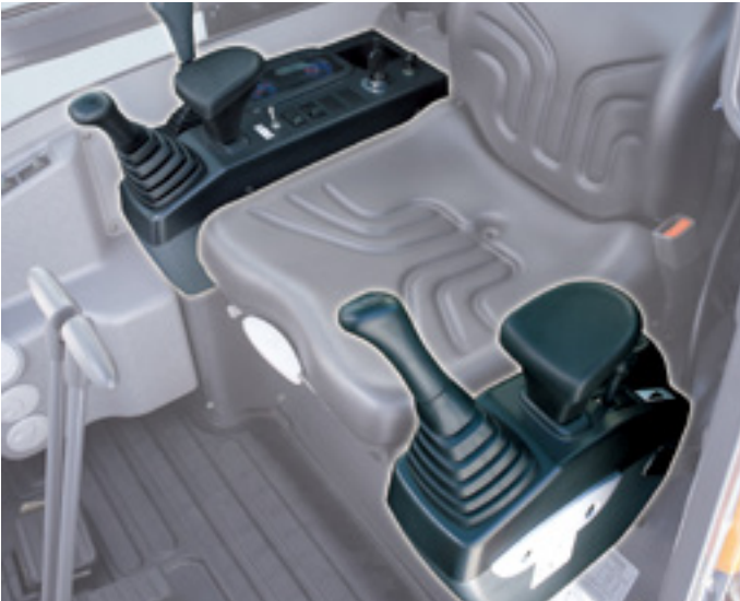
Conjuntos de controles Los conjuntos de controles izquierdo y derecho están ubicados de manera ergonómica para que su operación sea conveniente. Los mismos poseen una superficie amplia, tal que permite la instalación de diferentes opciones de conmutadores y controles. Su diseño compacto realizado en material sintético, contribuye a que la cabina presente un ambiente confortable para el operador.
