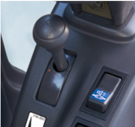
Palanca de control E/G La palanca de control del motor está localizada en una ubicación conveniente y muy accesible para el operador, lo cual le permite controlar el régimen del motor en forma fácil.
