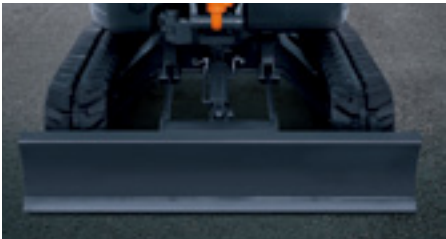
Pala frontal La pala frontal soldada y compacta provee durabilidad inclusive bajo duras condiciones de trabajo 1,700 mm x 350 mm (5'7" x 1'2")
