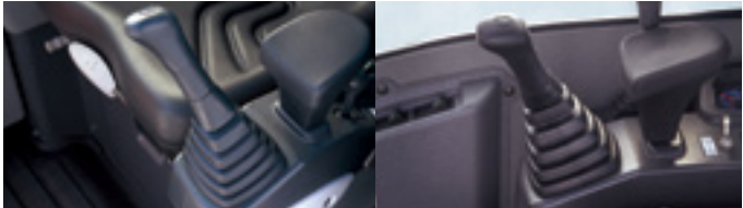
Joystick Las palancas joystick de tipo hidráulico poseen agarres muy confortables que permiten al operador llevar a cabo operaciones precisas de una manera fácil.
