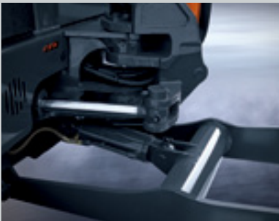
Giro de la pluma La conveniente función de giro de la pluma confiere la capacidad de efectuar trabajos en áreas muy estrechas. El soporte giratorio de nuevo diseño y el potenciado tamaño del cilindro de de la pluma aseguran una función de giro de pluma estable y de alto rendimiento.
